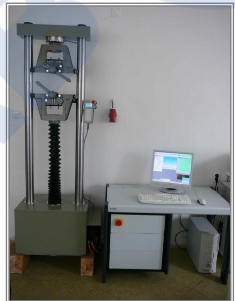
Modernizacja maszyny WEB ZD 10/90 (100 kN)
